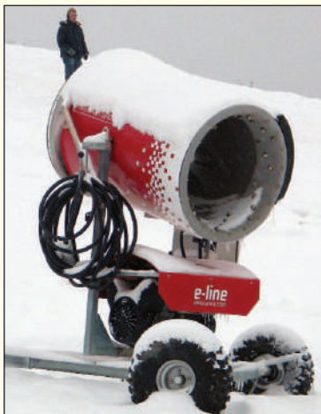
Unul dintre cele patru tunuri pentru producerea zăpezii
